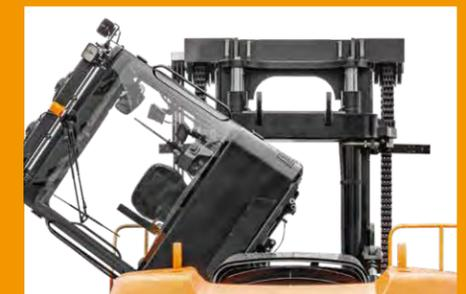
Kabine durch elektrischen Zylinder hochklappbar.
